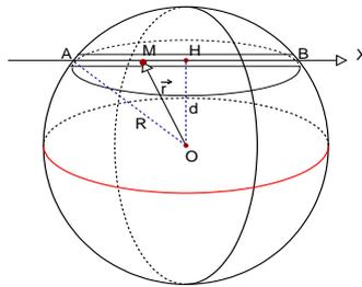
1. Soit  $M$  la position du point matériel telle que  $\overrightarrow{OM} = r\vec{e}_r$ . Rappelons que  $M$  va subir l'effet d'attraction de la sphère de rayon  $r$  et donc de masse  $M_r$ , si l'on considère que la masse volumique de la terre est constante  $\rho_T = M_T / (4\pi R_T^3/3)$
