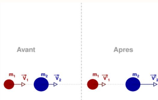
$$\begin{cases} m_1 (V_1 - V'_1) = -m_2 (V_2 - V'_2) \\ m_1 (V_1 - V'_1) (V_1 + V'_1) = -m_2 (V_2 - V'_2) (V_2 + V'_2) \end{cases}$$
