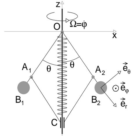
$OA_1A_2C$  forme un losange qui reste constamment dans le plan  $Oxz$ .  $(S)$  peut tourner autour de l'axe  $(OC)$  avec la vitesse angulaire  $\Omega = \dot{\varphi}$ . Le point  $O$  est fixé à l'axe alors que le point  $C$  peut glisser sans frottement le long de  $Oz$ .
