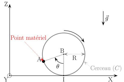
On pose  $J = MR^2$ , le moment d'inertie de ( $C$ ) en  $B$  par rapport à l'axe qui passe par  $B$  et parallèle à ( $OY$ ). Le vecteur rotation de ( $C$ ) par rapport à  $\mathcal{R}$  est  $\vec{\Omega} = \dot{\theta}\vec{j}$ .
