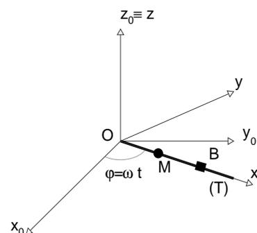
A l'instant initial  $t = 0$ , la tige ( $T$ ) est confondue avec l'axe  $Ox_0$  et la masselote est lancée depuis le point  $O$  avec une vitesse  $\vec{v}_0 = v_0 \vec{i}$  où  $v_0 > 0$ .
